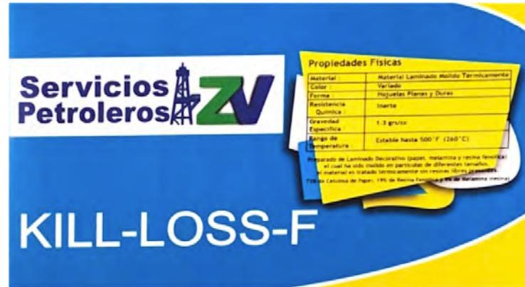
Es un químico estable, hecho a base de un laminado térmico que es utilizado para corregir la pérdida de circulación de fluidos base agua, aceite, en sintético y en cementaciones.
