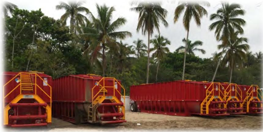
Son utilizados para el almacenamiento de fluidos de perforación, lodos de fractura; poseen válvulas de entrada y salida que permiten llenar y vaciar el tanque para facilitar la limpieza. El interior ha sido revestido con pinturas epóxicas resistentes a los ácidos y el petróleo.
